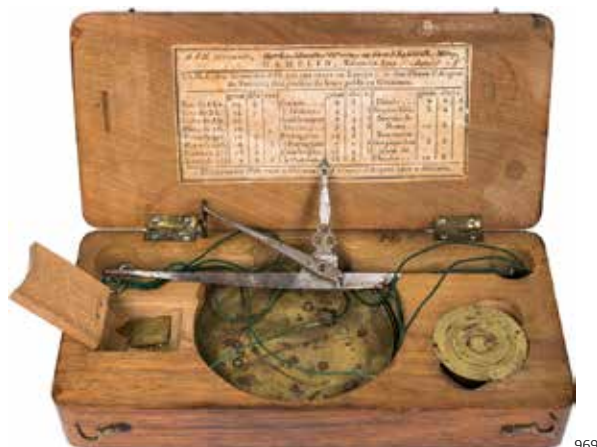
969 PARIS, Hamelin, 1802-1845, Rue St. Martin, no. 29, en face l'église St.-Mery. Münzwaage o. J., Rechteckiger Kasten aus Nussbaumholz mit zwei Vorderschließen, Maße: 198 x 89 x 37 mm, im Innendeckel Firmenetikett mit Münztabelle, Waage aus Stahl mit flachen Enden und zwei großen runden Messingschalen an grünen Schnüren, 7-teiliges Einsatzgewicht von 1 Gr (fehlt) bis 50 Grammes, alle Gewichte mit Meisterzeichen „H couronné“, unter dem Holzkläppchen 5 DÉCIG-Gewichte, Lavagne 387. vz
