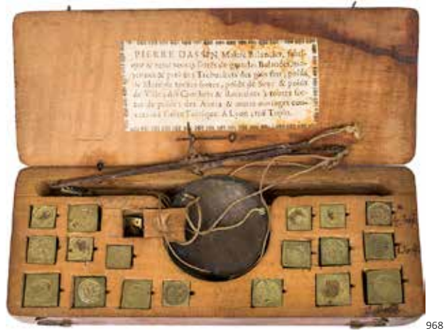
968 Pierre Dassin, 1724-1730, Rue Tupin. Münzwaage o. J., Rechteckiger Kasten aus Birnbaumholz mit zwei Vorderschließen, in Innendeckel mittig das Meisteretikett mit 7 Zeilen Schrift, Maße: 202 x 80 x 25 mm, Waage aus Stahl mit flachen Enden und zwei runden Messingwaagschalen an hellbraunen, beschädigten Schnüren, 18 Bildergewichte, davon mindestens 9 mit „PD“, die übrigen nicht oder mit undeutlichen Herstellerzeichen gemarkt, unter dem Holzschieber 7 Grain-Gewichte, Lavagne Nr. 308/316. ss
